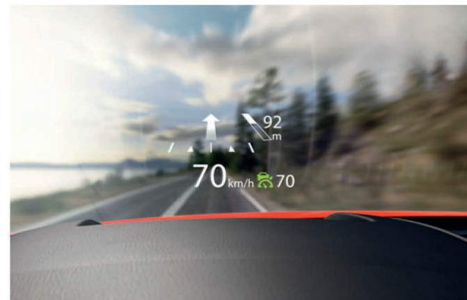
Affichage tête haute projeté (ADD) avec reconnaissance des panneaux de signalisation (TSR) (uniquement avec Pack Dynamique Plus)
